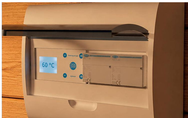
Рисунок 2 — Блок управления «ТермоНСК» Т1: экран, кнопки температуры/времени и силовые модули размыкателя под ними
